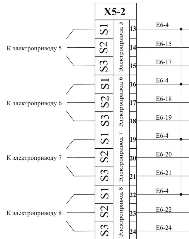
Модуль контроля концевых выключателей для APC-3М
